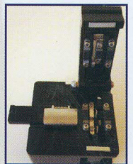
ใช้ตัวยึดสาย และตัดปลาย
